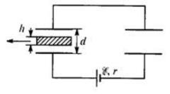
быстро выдвигают из конденсатора так, что заряды на обкладках этого конденсатора не успевают измениться. Определить величину и направление тока через батарею сразу после удаления пластины.
